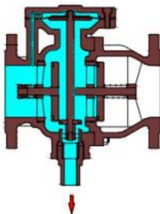
当下游压力比上游高，上游止回阀处于漏水状态下底部排水，水不会进入上游。
