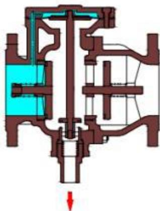
当下游压力比上游高，上下游止回阀处于关闭状态，底部不会排水，水不会进入上游。
