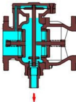
当下游压力比上游高，上下游止回阀处于关闭状态，底部排水。
