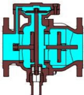
当上游压力比下游高，上下游止回阀处于正常工作下，底部不会排水。
